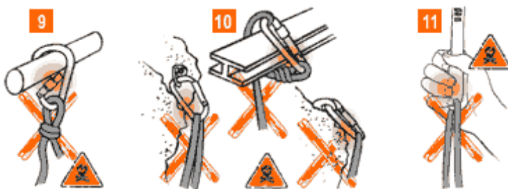
Illustrazione 4.4: Scorretto posizionamento dei connettori
