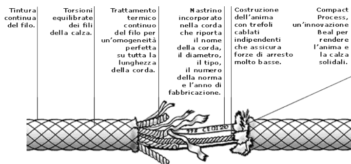
Illustrazione 4.1: Sezione di fune
